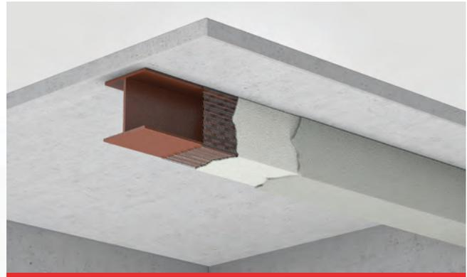
Mit der Putzbekleidung von Stahlstützen und Trägern werden die Feuerwiderstandswerte von 30 bis 180 Minuten erreicht. Eine Putzbekleidung unter Verwendung von Rippenstreckmetall und den darauf aufgetragenen HBT-Brandschutzputzen M1 (Vorspritzer) und dem HBT-Brandschutzputz M2 verbinden sich einige Vorteile.
