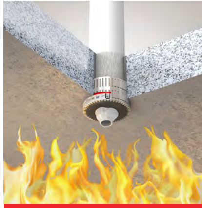
Die intumeszierende Brandschutzeinlage der Rohrmanschette expandiert und drückt das Kunststoffrohr zusammen.
