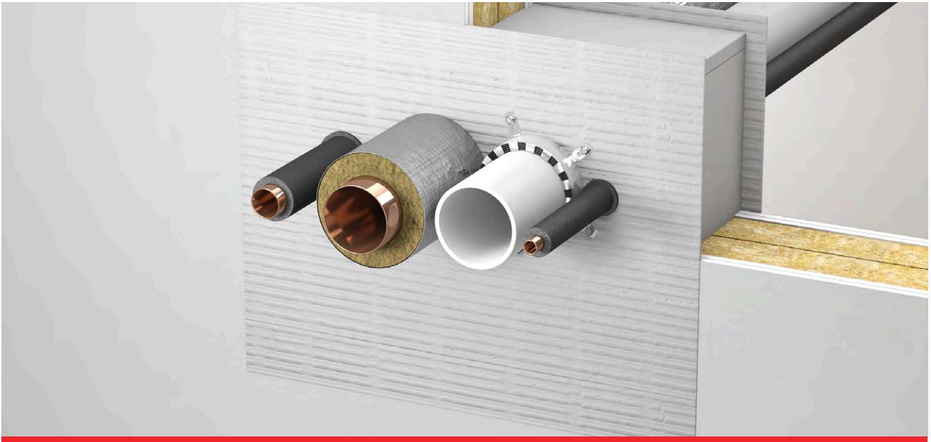
Rohrabschottung von brennbaren und nichtbrennbaren Rohren mittels ISILASTIK Kombischott B5 EI 90 / EI 120 in leichten Trennwänden
