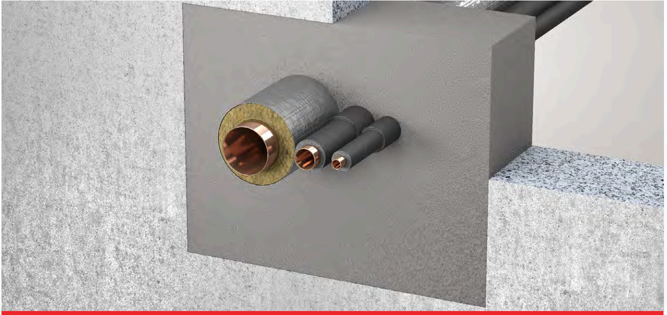
Rohrabschottung nichtbrennbarer Rohre mit nichtbrennbarer und brennbarer Isolierung in Massivwänden und Decken. Bauteilverschluss mit HBT-Brandschutzmörtel M3
