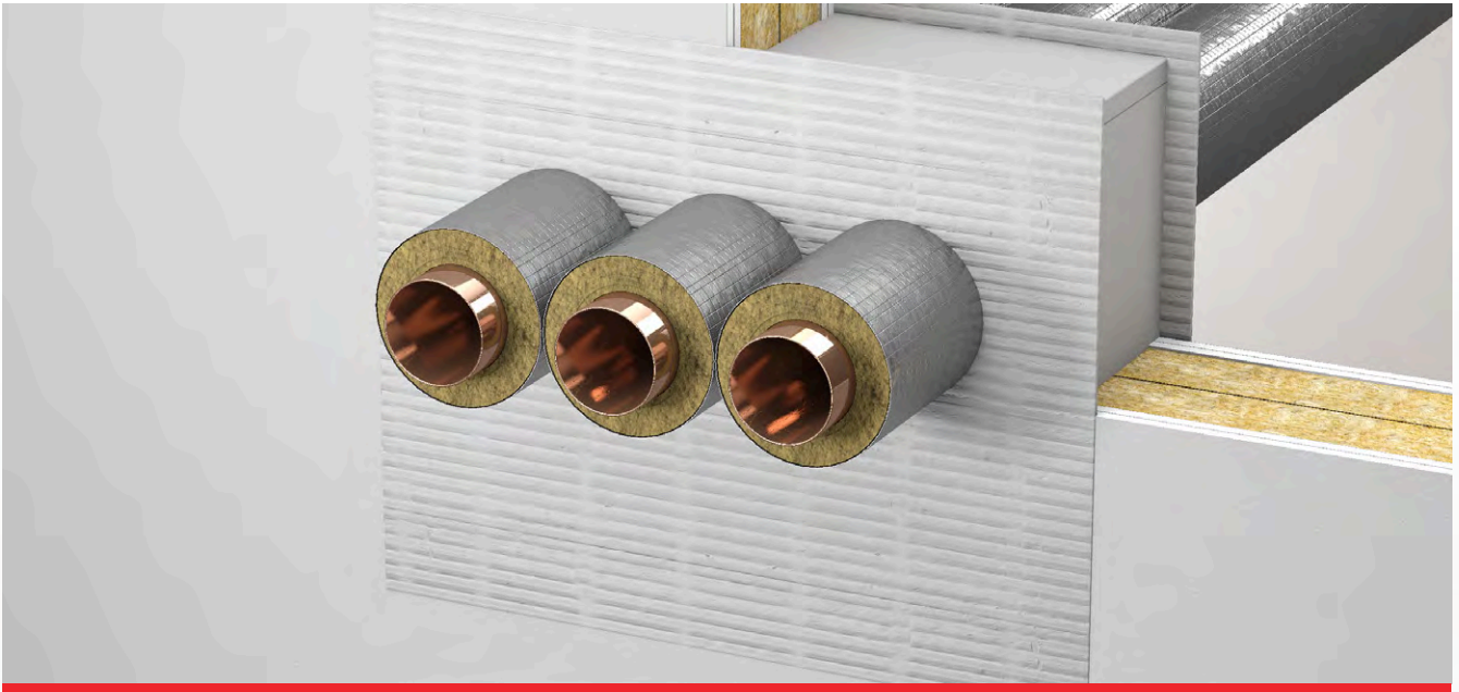
Rohrabschottung von nichtbrennbaren Rohren mit nichtbrennbarer Isolierung mit dem ISILASTIK Kombischott B5 EI 90 / EI 120 in leichten Trennwänden
