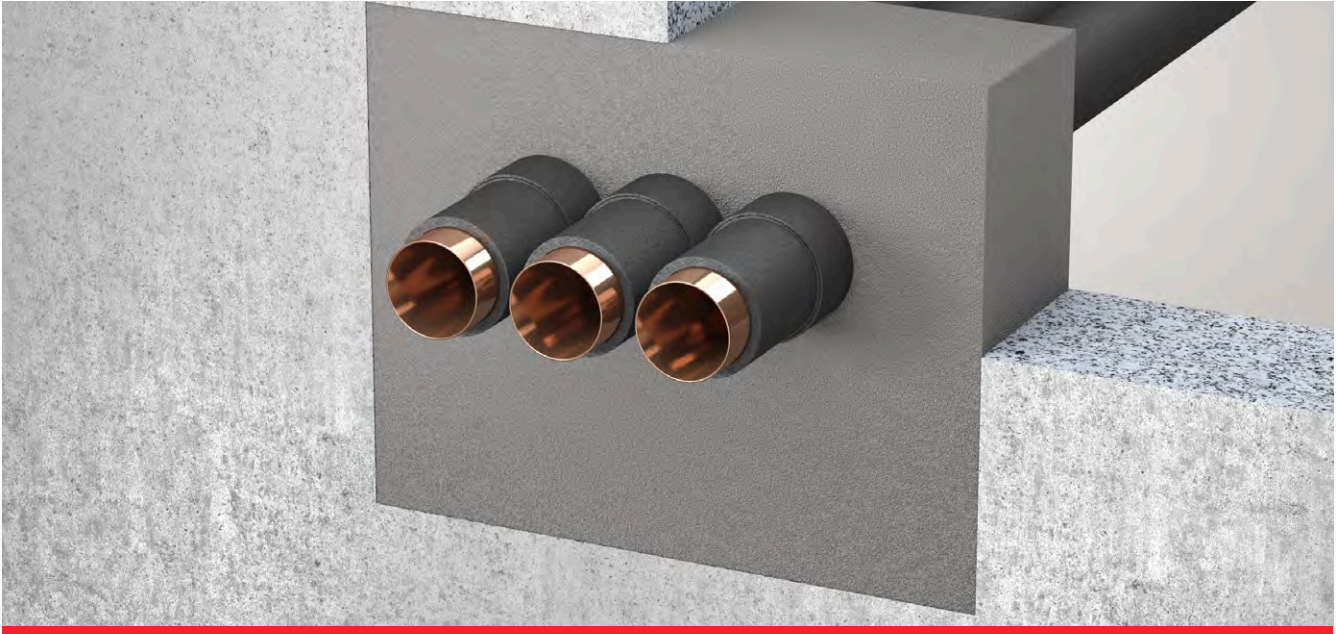
Rohrabschottung nichtbrennbarer Rohre mit brennbarer Isolierung im Massivbauteil, Bauteilverschluss mit HBT-Brandschutzmörtel M3
