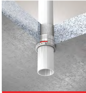
ISITHERM Rohrmanschette BBR in Massivdecke eingemörtelt mit HBT Brandschutzmörtel M3
