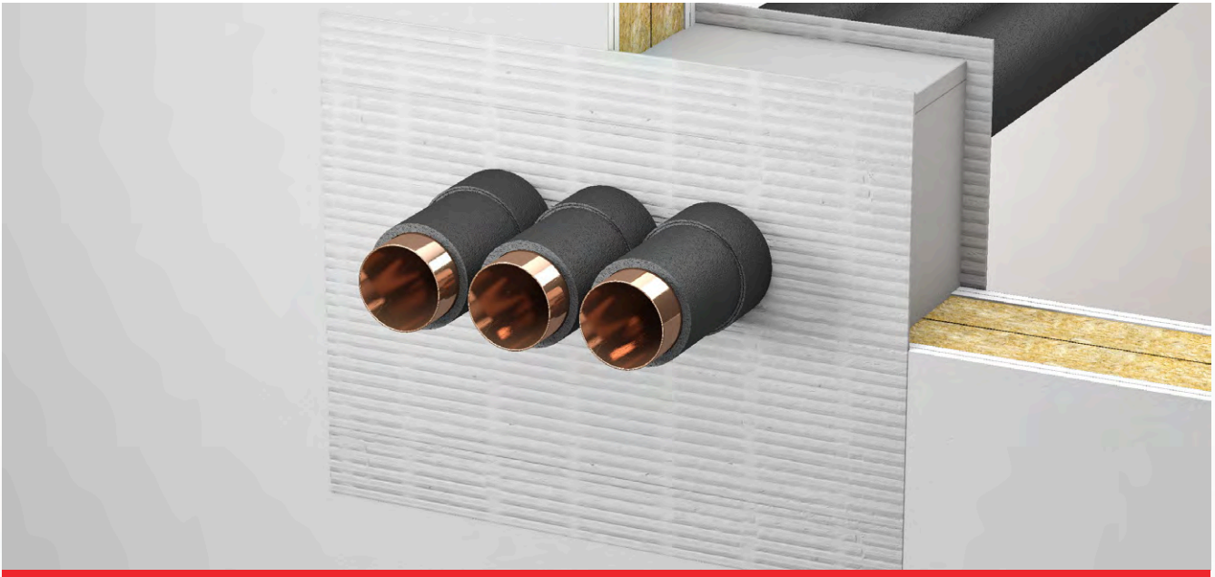
Rohrabschottung von nichtbrennbaren Rohren mit brennbarer Isolierung in leichten Trennwänden mit dem ISILASTIK Kombischott B5 EI 90 / EI 120
