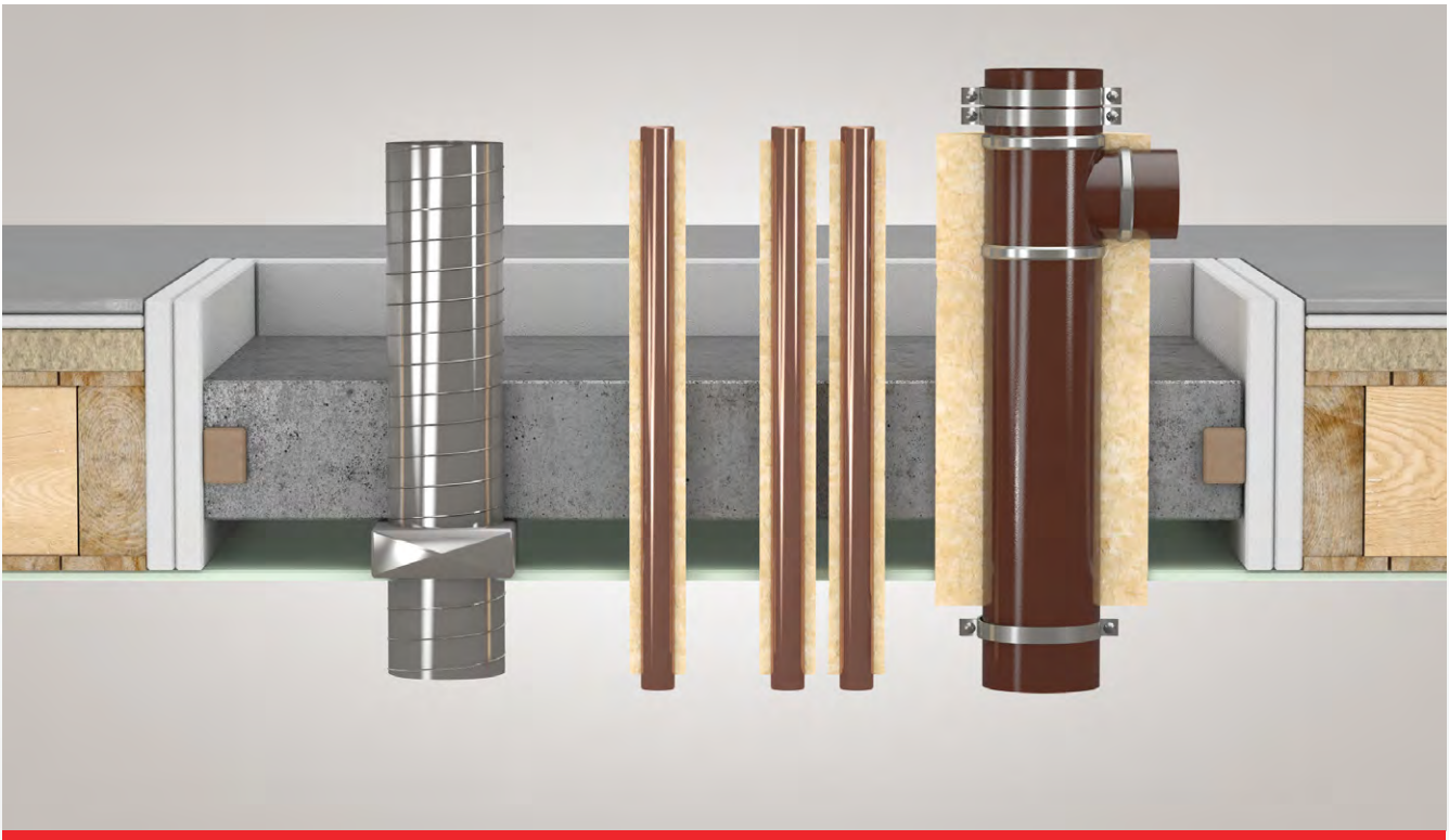
Beispielhafte Darstellung eines Mörtelschotts in einer Holzbalkendecke
