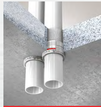
ISITHERM Rohrmanschette BBR mit Nullabstand in Massivdecke mit HBT Brandschutzmörtel M3 eingemörtelt
