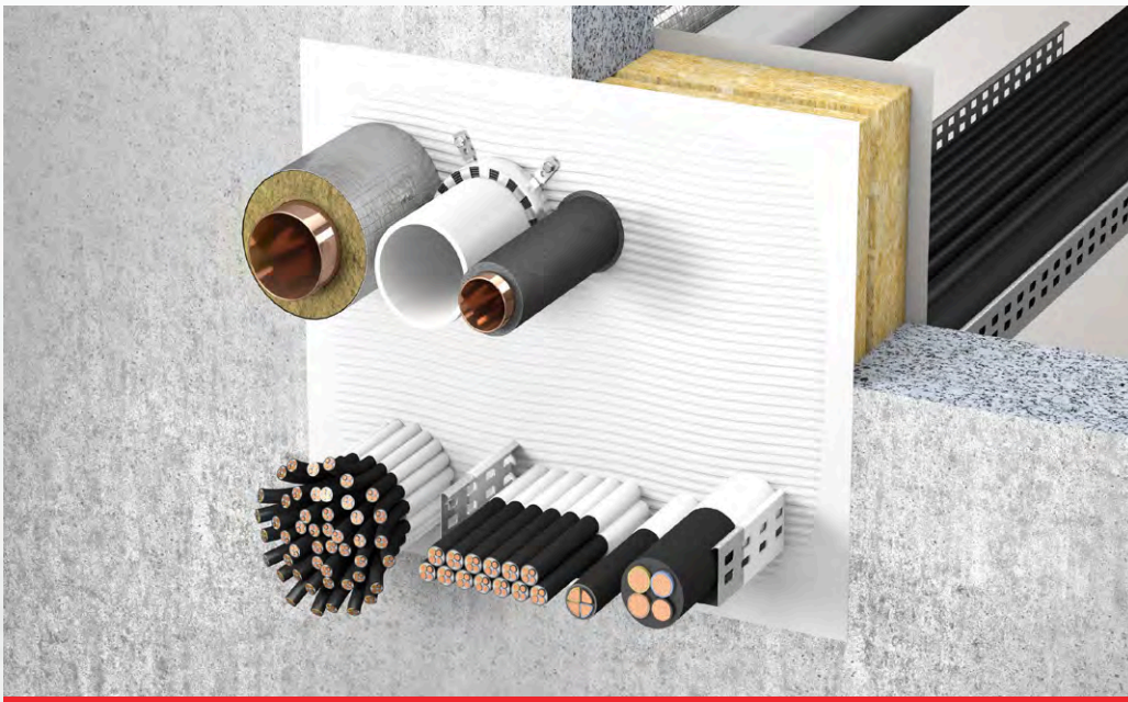
Für die Abschottung von brennbaren und nichtbrennbaren Rohren, sowie Kabeln in Bauteilöffnung von Massivwänden, leichten Trennwänden und Massivdecken sind die ISILASTIK B5 Kombischotts EI 90 / EI 120 zu verwenden. Details dazu entnehmen Sie dem HBT-Themenkatalog 03, Kombiabschottungen.
