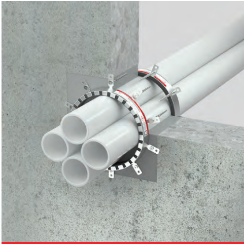
Mehrfachbelegung einer ISITHERM-Rohrmanschetten BBR II, mit bis zu zu 4 brennbaren Rohren \varnothing \leq 75 mm
